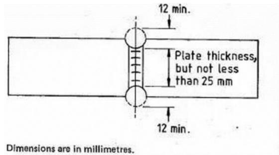
**Gambar 3.** Spesimen Uji Tarik Standar BS 709
