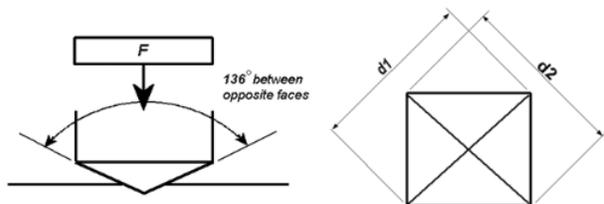
**Gambar 1.** Skema Uji Kekerasan Metode *Vickers*
