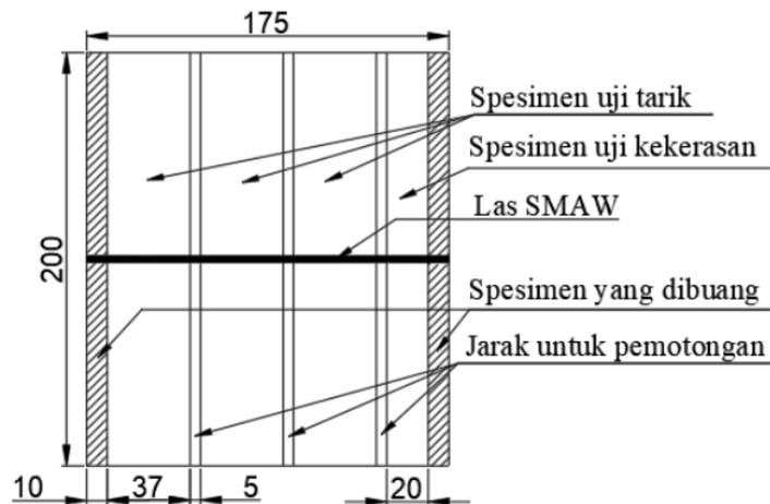
**Gambar 2.** Model Pemotongan Spesimen
