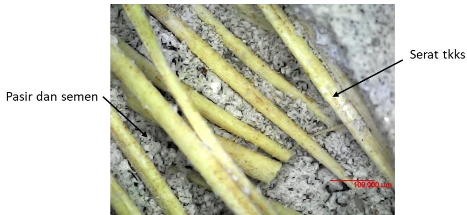
Gambar 8. Permukaan patah PRC
