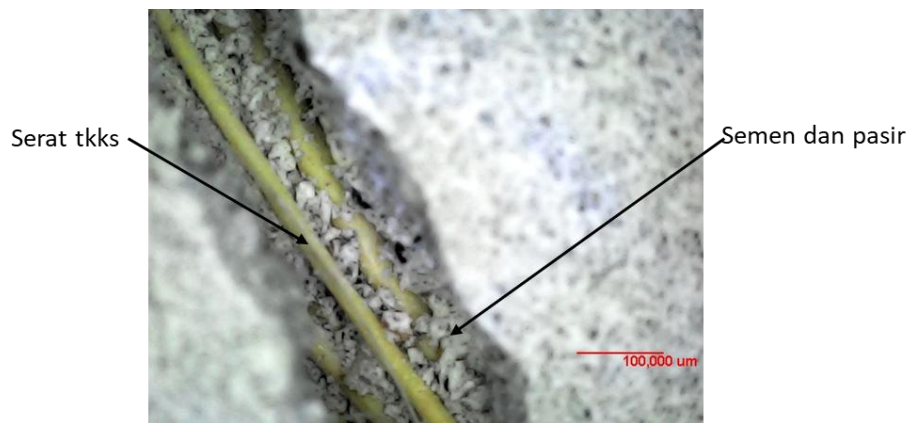
Gambar 9. Permukaan patah PRC
