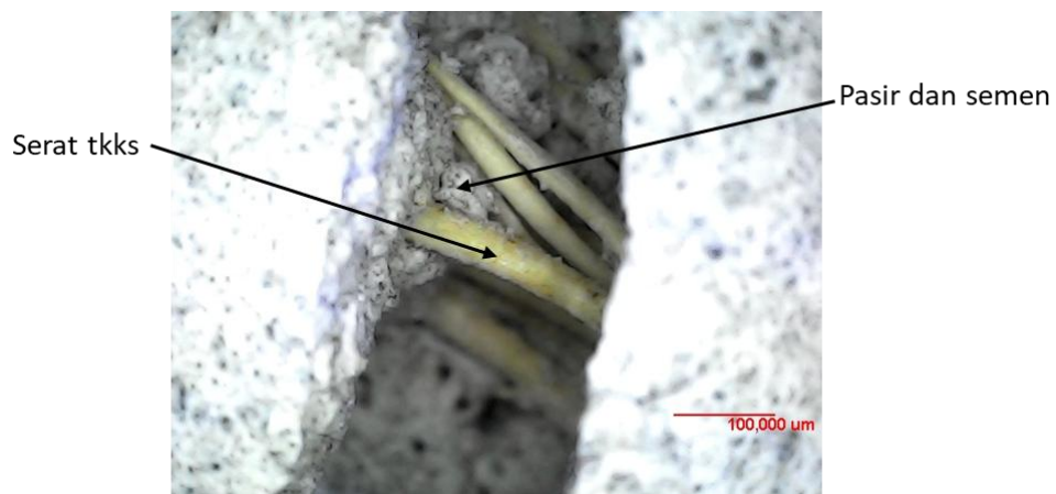
Gambar 6. Permukaan patah PRC
