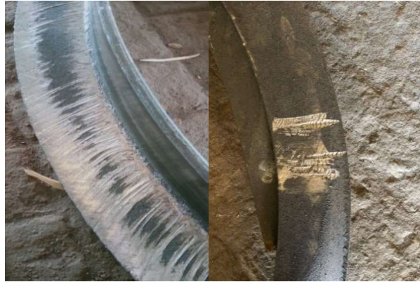
Gambar 2. Cacat Scratch Setelah Pengerolan
