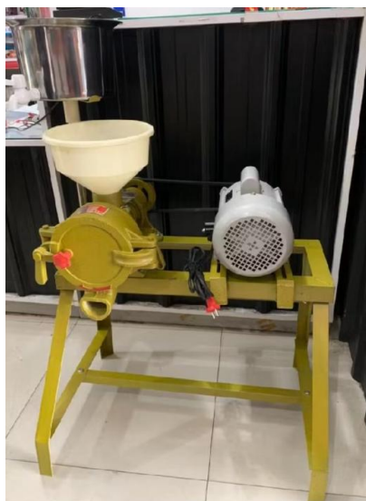
Gambar 3. Mesin penggiling kedelai sistim rotari untuk pembuatan Tahu
